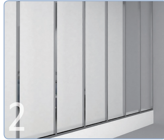
2 C-STUD를 600mm이내 간격으로 상·하부 RUNNER 사이에 수직으로 설치한다
